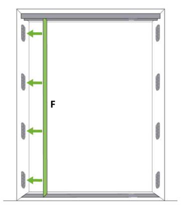
**8.** Enfin, aligner et clipser le coffre **(A)** sur les plaques de fixations **(D)** ou dans le profil de pose facile **(F)**. Commencer par incliner le coffre vers le haut et l'enclencher dans le rail supérieur. Puis enclencher progressivement le coffre dans le rail inférieur et le profil d'installation facile ou les plaques. ATTENTION! La chaîne doit être placé en bas.
