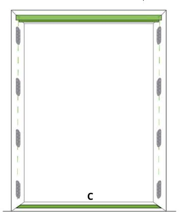
**7.** Placer le profil de réception aimanté **(F)** sur les plaques **(D)** et clipser les ensembles. ATTENTION ! Lors de la pose du profil de réception, vérifier le sens du joint aimanté par rapport à celui présent dans le profil mobile.
