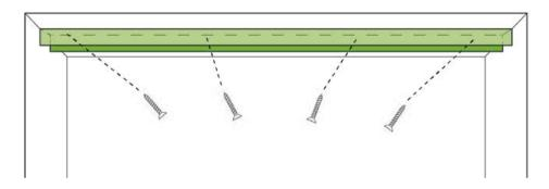
**4.** Aligner 4 plaques de fixations **(D)** à la verticale d'un côté et vérifier à l'aide d'un niveau. Percer, puis fixer les plaques au mur avec les vis et chevilles.
