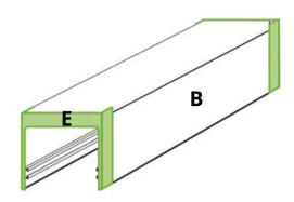
1. Insérer les caches du rail supérieur (E) de chaque côté du rail (B)
